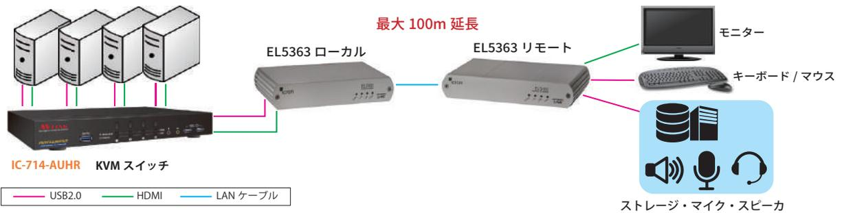
KVMエクステンダーに接続したキーボード(ホットキー)/マウスにて切り替えを行う場合、KVMエクステンダー(ローカル)をKVMスイッチのUSB1.1(キーボード/マウス)ポートに接続して下さい。
