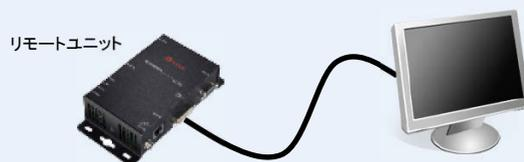
※IRを延長する際、リモートユニット本体の受光部を用いない場合はリモートユニットの"IR2 IN"にIR受信ケーブルを接続してください
